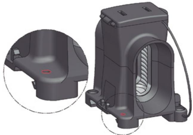
Sistema antitracción en carril mediante tornillo Ø3
