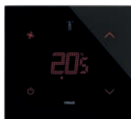
21514.F.76 Termostato táctil (calefacción y aire acondicionado), mando VENTIL- CONVECTORES de 3 velocidad y proporcional, clase I (contribución 1%) en modo ON/OFF, clase IV (aportación 2%) en modo PID, posi- bilidad de interfaz con actuador 01466.1 para realizar un termostato modulante de clase V (aportación 3%), 1 entrada para sensor 20432, 19432, 14432 o 02965.1, 1 entrada digital programable, retroilumina- ción LED RGB, negro diamante - 2 módulos. Prof.: 30,2 mm
