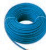
01840.E.B Cable para sistema de difusión de sonido Bus By-me, 2x0,50 mm 2 , con vaina LSZH, clase CRP Eca, para cables de categoría I (U0 = 400 V), azul - 100 m
