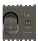
19411.16.6.M C 16, I_{\Delta n} 6 mA poder de corte 3000 A - 2 módulos. Profundidad: 39 mm
