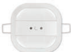
01527 Detector de presencia IR de 360°, ON/OFF y regulación de luces, calefacción, climatización, ventilación, alcance de luminosidad 1-1000 Lux, estándar KNX, para la instalación de techo. Dimensiones: 80x80x45 mm
