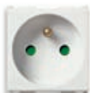
14212.AB Toma SICURY 2P+T 16 A 250 V~, estándar francés - 2 módulos. Profundidad: 25,4 mm
