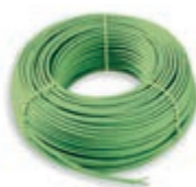
01890.E Cable para sistemas KNX, 2x2x0,8 mm, vaina LSZH, Clase CPR Eca, adecuado para cables de I categoría (U0 = 400 V), verde - 100 m
