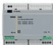
01901 Amplificador estéreo 2 salidas para altavoces 8 \Omega 10+10 V~, alimentación 110-230 V 50/60 Hz, terminador de línea incorporado, 6 módulos de 17,5 mm
