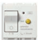
14411.16.30 C 16, I_{\Delta n} 30 mA poder de corte 3000 A - 2 módulos. Profundidad: 38 mm
