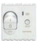
19411.16.6.B C 16, I_{\Delta n} 6 mA poder de corte 3000 A - 2 módulos. Profundidad: 39 mm
