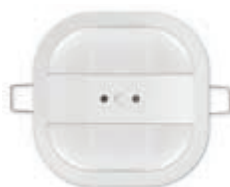
01529.1 Detector de presencia IR de 360°, ON/OFF luces, alcance de luminosidad 1-1000 Lux, estándar KNX, para la instalación de techo. Dimensiones: 91x91x45 mm
