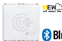
20462.B Lector externo de tarjeta inteligente NFC/RFID, configura- ción de tarjeta mediante la aplicación View Wireless con protocolo estándar Bluetooth, tecnología IoT con protocolo Bluetooth® wireless technology 5.0 para la realización de sistema mesh View Wireless, 1 salida de relé NO 16 A 100- 240 V~ 50/60 Hz, 1 entrada DND, LED RGB con regulación de intensidad, alimentación 100-240 V~ 50/60 Hz - 2 módulos. Prof.: 32 mm
