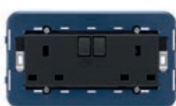
19222.4 2 x SICURY 2P+T 13 A, + interruptor 2P. Profundidad: 17,5 mm
