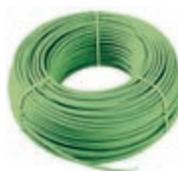
01890.C Cable para sistemas KNX, 2x2x0,8 mm, vaina LSZH, Clase CPR Cca s1b d1 a1, adecuado para cables de I categoría (U0 = 400 V), verde - 100 m
