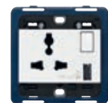
■ 19266.A.B SICURY 2P+T 13 A 250 V~ multi-estándar, con interruptor 2P y 1 USB-A. Profundidad: 21 mm
