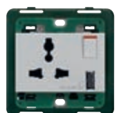
■ 14266.A.SL SICURY 2P+T 13 A 250 V~ multi-estándar, con interruptor 2P y 1 USB-A. Profundidad: 21 mm
