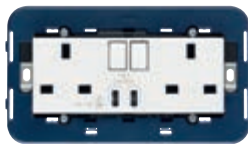
▲ 19224.CC.B SICURY 2P+T 13 A 250 V~ con 2 interruptores 2P y 2 USB-C. Profundidad: 22,8 mm
