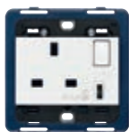
▲ 19223.C.B SICURY 2P+T 13 A 250 V~ con interruptor 2P y 1 USB-C. Profundidad: 22,8 mm
