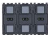
21126 6 pulsadores independientes, 8 entradas no polarizadas, 7 salidas en estado sólido para contactos no polarizados, alimentación 9-32 Vdc - 3 módulos. Prof.: 22,8 mm
