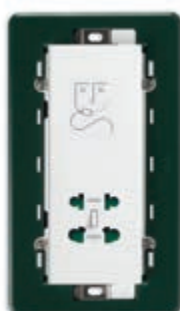
14291 6 230 V~ 50/60 Hz, con transformador de aislamiento 20 VA, salidas 230 V~ y 120 V~. Profundidad: 41 mm
