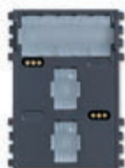
21457.1 Lector táctil de tarjetas de transponder Eikon Tactil, estándar KNX, 2 salidas de relé NO 4 A 24 V~, 2 entradas, alimentación 12-24 V~ 50/60 Hz y 12-24 Vcc (SELV) - 3 módulos. Suministrado sin tarjeta con transponder. Profundidad: 36,5 mm
