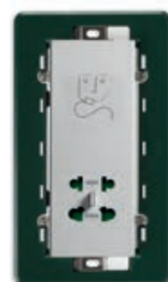
14291.SL 6 230 V~ 50/60 Hz, con transformador de aislamiento 20 VA, salidas 230 V~ y 120 V~. Profundidad: 41 mm
