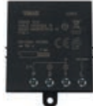
03993 Módulo de relé magnético por impulsos secuenciales ON/OFF, 1 entrada para pulsador NO, 2 salidas secuenciales de relé 10 A, alimentación 220-240 V~ 50/60 Hz, montaje en cajas de derivación o de empotrar
