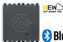
20462 Lector externo de tarjeta inteligente NFC/RFID, configura- ción de tarjeta mediante la aplicación View Wireless con protocolo estándar Bluetooth, tecnología IoT con protocolo Bluetooth® wireless technology 5.0 para la realización de sistema mesh View Wireless, 1 salida de relé NO 16 A 100- 240 V~ 50/60 Hz, 1 entrada DND, LED RGB con regulación de intensidad, alimentación 100-240 V~ 50/60 Hz - 2 módulos. Prof.: 32 mm
