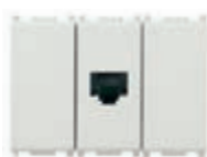
14505.AB Módulo de relé con toma RJ45 para pulsador de llamada de mano, 2 luces + 2 AUX, conexión a un módulo 8IN/8OUT o una pantalla Call-way, 4 salidas de relé 24 V NO, tratamiento antibacteriano - 3 módulos. Profundidad: 29,5 mm
