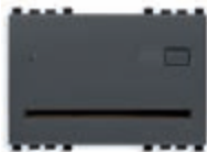
Δ 20461 Lector/programador tarjeta smart card, 12-24 V~ 50/60 Hz/12-24 Vdc (SELV) - 3 módulos. Prof.: 37 mm
