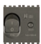
19411.16.M C 16, I_{\Delta n} 10 mA poder de corte 3000 A - 2 módulos. Profundidad: 39 mm
