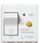
14411.06 C 6, I_{\Delta n} 10 mA poder de corte 1500 A - 2 módulos. Profundidad: 38 mm
