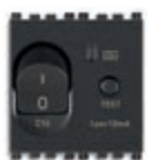
19411.16 C 16, I_{\Delta n} 10 mA poder de corte 3000 A - 2 módulos. Profundidad: 39 mm
