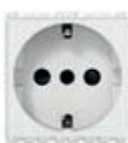
19209.B 16 A, P30 - 2 módulos. Profundidad: 29 mm
