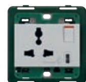
▲ 14266.C.SL SICURY 2P+T 13 A 250 V~ multi-estándar, con interruptor 2P y 1 USB-C. Profundidad: 22,8 mm
