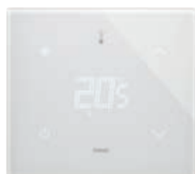
21514.F.70 Termostato táctil (calefacción y aire acondicionado), mando VENTIL- CONVECTORES de 3 velocidad y proporcional, clase I (contribución 1%) en modo ON/OFF, clase IV (aportación 2%) en modo PID, posi- bilidad de interfaz con actuador 01466.1 para realizar un termostato modulante de clase V (aportación 3%), 1 entrada para sensor 20432, 19432, 14432 o 02965.1, 1 entrada digital programable, retroilumina- ción LED RGB, blanco diamante - 2 módulos. Prof.: 30,2 mm
