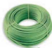
01890.E Cable para sistemas KNX, 2x2x0,8 mm, vaina LSZH, Clase CPR Eca, adecuado para cables de I categoría (U0 = 400 V), verde - 100 m
