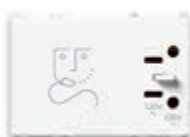
14290 230 V~ 50/60 Hz, con transformador de aislamiento 20 VA, salidas 230 V~ y 120 V~ - 3 módulos
