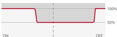
Luminaria con balasto magnético bipotencia y dispositivo de conmutación con mando por línea de mando suplementaria (mando piloto).
